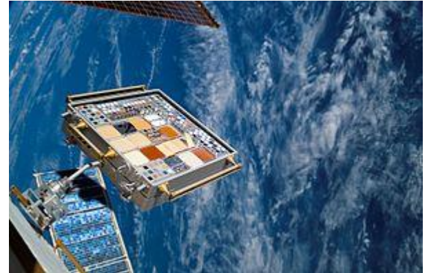
Экспериментальные образцы, экспонируемые в открытом космосе. 13 августа 2007 года
